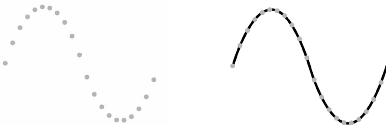
Рис. 17. Серия выборок, представляющих синусоиду (слева); реконструированная синусоида (справа).
